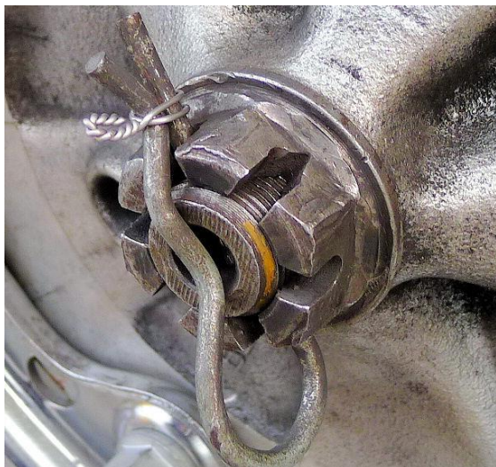
Federstecker min. 4mm, drahtgesichert
