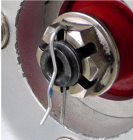
loser, zu dünner, ungesicherter Federstecker
